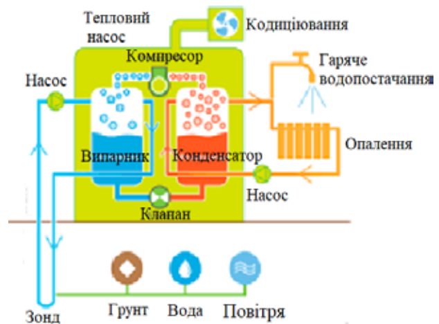
Рис. 1. Принципова схема парокомпресійного ТН
